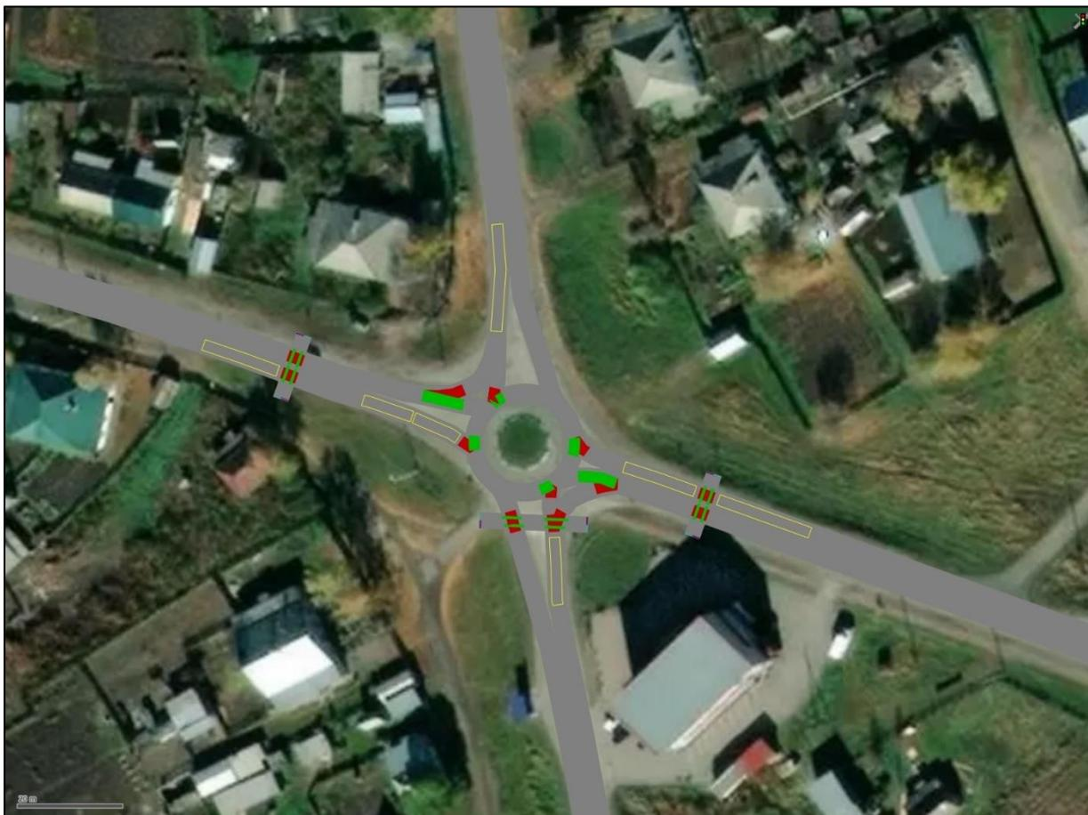
Рисунок 12 – Пример ввода зон малоскоростного движения на перекрестке
