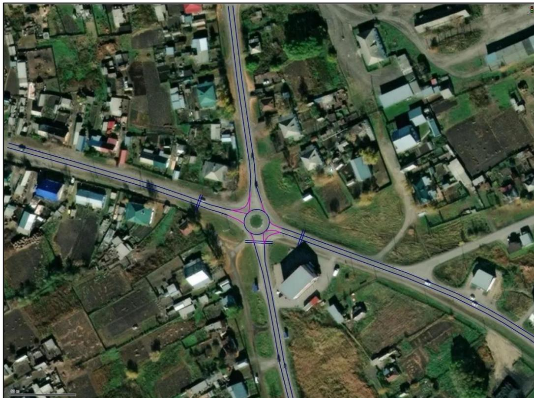
Рисунок 4 - Пример ввода УДС на пересечении ул. Революционная и ул. Некрасова (отображение осей отрезков)
