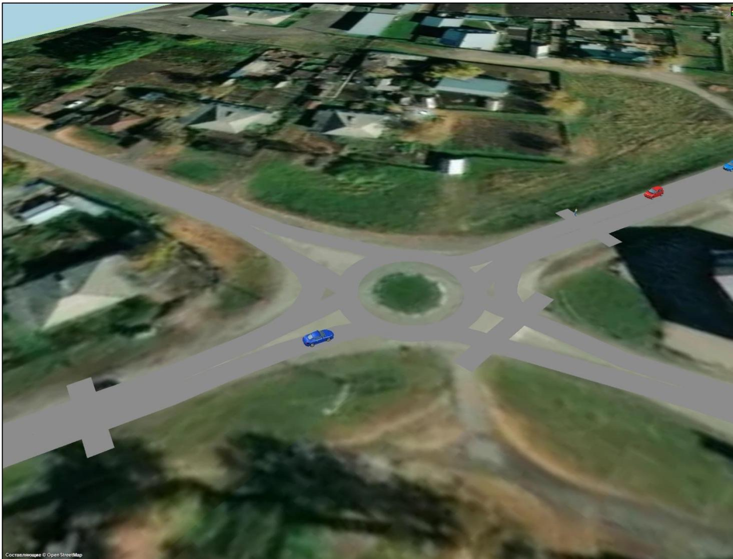
Рисунок 20 - Процесс имитации существующего варианта ОДД на пересечении ул. Революционная и ул. Некрасова
